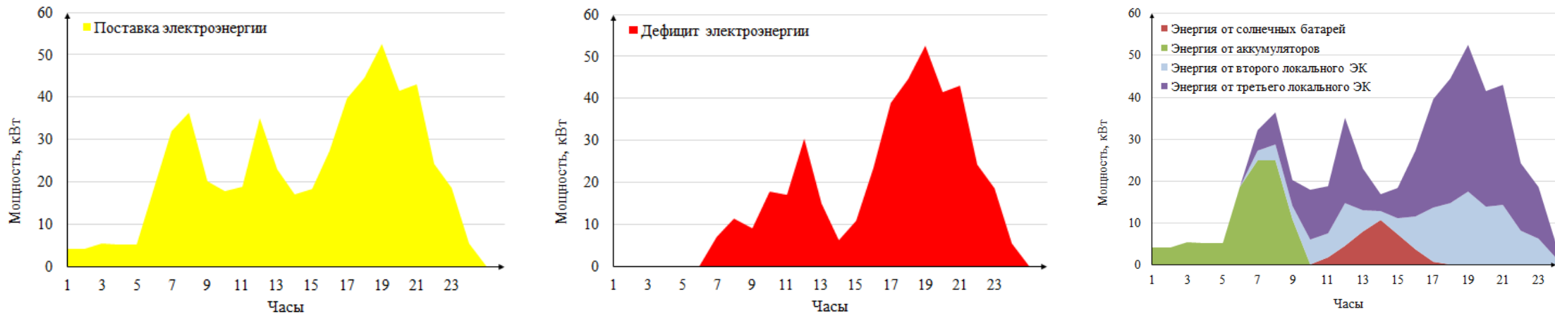
Рис. 6. Результаты моделирования взаимодействия трех локальных ЭК в условиях ЧС - выход из строя дизельного генератора
